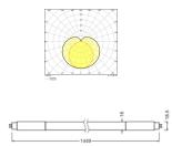
Technische Daten Ledvance LED Röhre T5 Performance (HF) High Efficiency 18W 2550lm - 830 | 145cm - Ersatz für 35W
