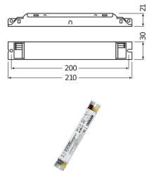
**Caractéristiques Osram LED driver Optotronica Fit 50 / 220-240V / 250 / D**
