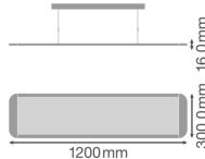
**Caractéristiques Ledvance Dalle LED Direct/Indirect 30x120cm 4000K 36W UGR <19 | Remplacement 2x36W**
