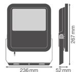
**Caractéristiques Ledvance Projecteur LED 100 Aluminium Blanc 69W 9150lm 100D - 830 | IP66 - Symétrique**
