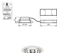
**Caractéristiques Philips Spot encastrable LED LuxSpace Mini DN560B 15.4W 2200lm 80D - 830 | 164mm - Aluminium Réflecteur**
